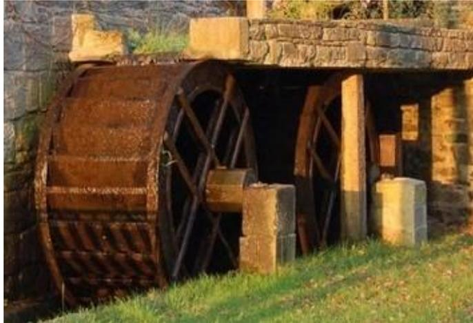
Dans les moulins à eau, les roues sont à aubes, à augets, horizontales ou verticales et entraînent les meules pour écraser, moudre, polir, broyer, concasser...
